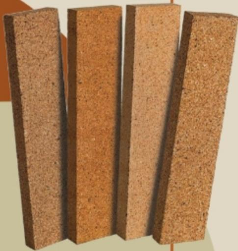
يتكون الطوب الناري من مواد حرارية ذات مقاومة عالية للحرارة وتحتفظ بخصائصها الفيزيائية والكيميائية عند درجات حرارة عالية. بالإضافة إلى مقاومته الحرارية العالية، فإن الطوب المصنوع من مواد حرارية يحافظ على مقاومته ضد التدهور الناتج عن التأثيرات الكيميائية والإجهاد الميكانيكي والتأثيرات.
